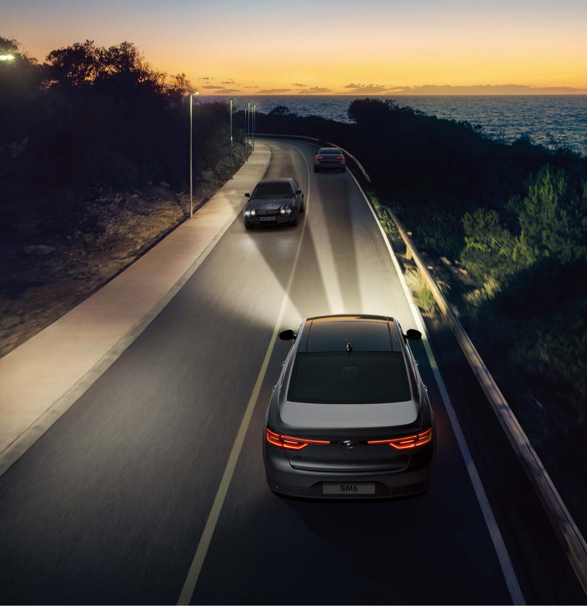
전방 카메라가 주행 상황을 스스로 인식하고, 상향등 내부 led(좌/우 총 36개)를 다중 제어하여 영역별 밝기를 정교하게 조정합니다. 운전자의 시야 확보는 물론 마주 오는 차량 운전자의 눈부심까지 방지하여 한 차원 높은 주행 안전성을 제공합니다.
