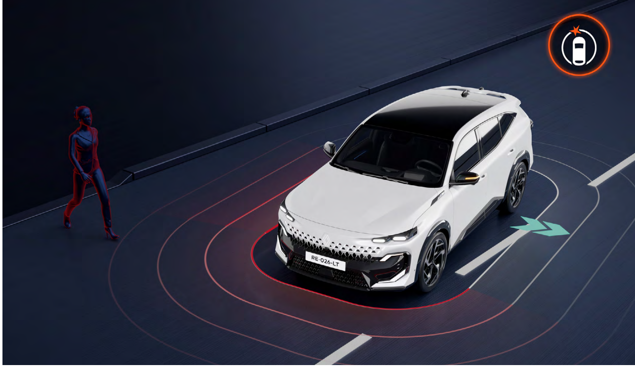
긴급 조향 보조 시속 60~90km의 중고속 운행 중 주행 차선 내 추돌 위험이 있는 차량이나 보행자가 감지되면 자동으로 안전 회피를 지원합니다.
