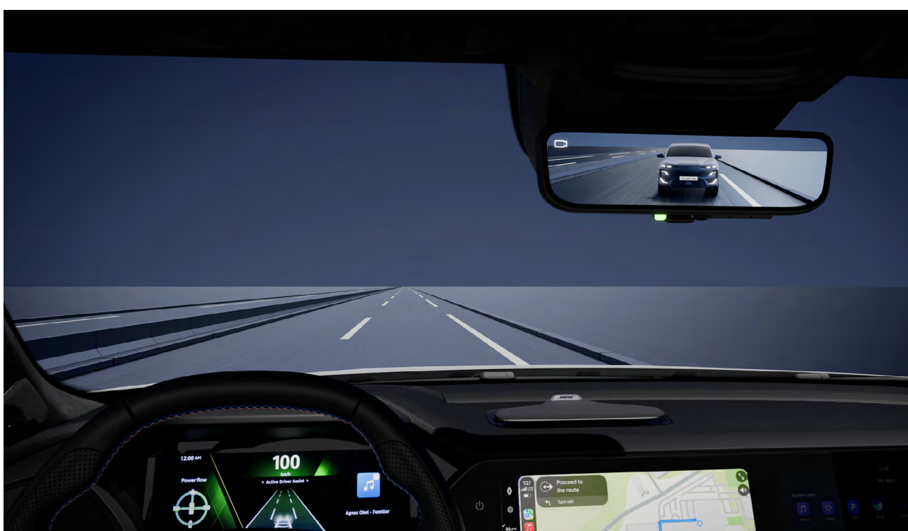
스마트 룸미러 리어 스포일러에 장착된 카메라와 후방 카메라 시스템을 연동해, 실내 룸미러 화면으로 시야를 제공합니다. 뒷좌석에 키가 큰 탑승자가 있어도 시야 방해 없이 후방을 선명하게 확인할 수 있습니다.
