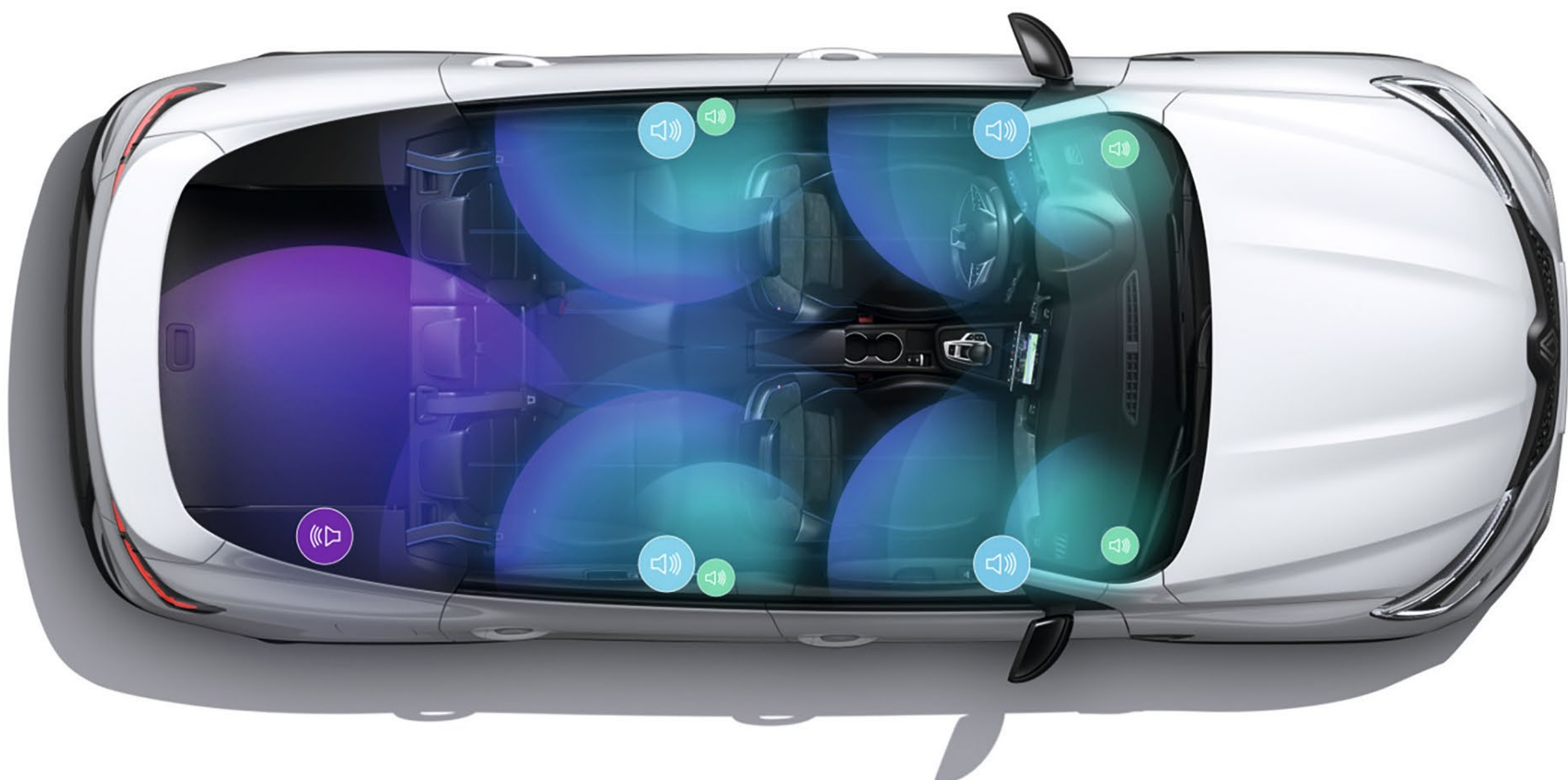
인스트루먼트 패널에 2개의 트위터, 도어 패널에 4개의 우퍼, 2열 도어 패널에 2개의 트위터, 그리고 트렁크에 1개의 서브우퍼로 구성
